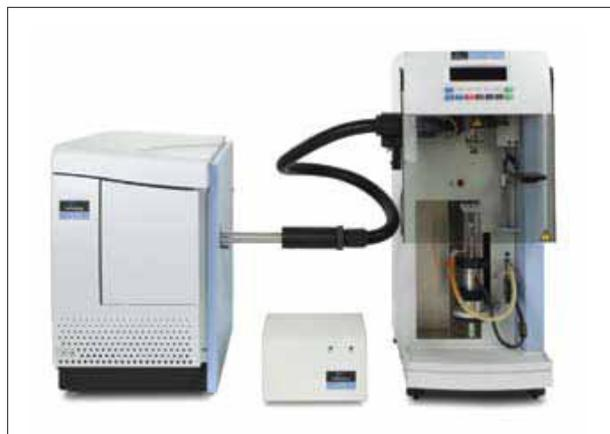
图2. 珀金埃尔默Clarus 600 C 质谱仪MS连接到Pyris 1 TGA。
