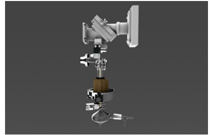
Avio 500的垂直炬管设计对任何样品类型都能提供最佳的性能
