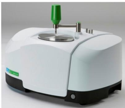
图 1. Spectrum Two 傅里叶变换红外光谱仪
